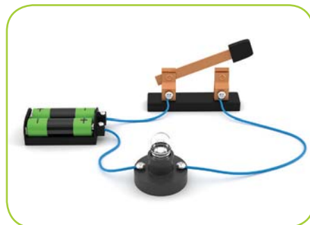
Abb. 22 Anschließen einer Lampe an den Stromkreis
